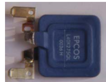
Erilaisten salamaiskujen taajuus Varistorin toiminta salaman eliminoinnissa Jokainen jännitepiikki lyhentää varistorin ikää
